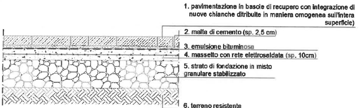
Figura 3 – Caratteristiche della modalità di posa delle basole.
